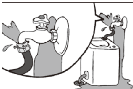
①洗衣机进水管和水龙头连接部分
